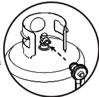
Diese Gasarmatur ist rechtsdrehend. Vergewissern Sie sich, dass der Tank vollständig abgestellt ist und schrauben Sie den Regler so weit wie möglich in das Ventil des Gastanks.
