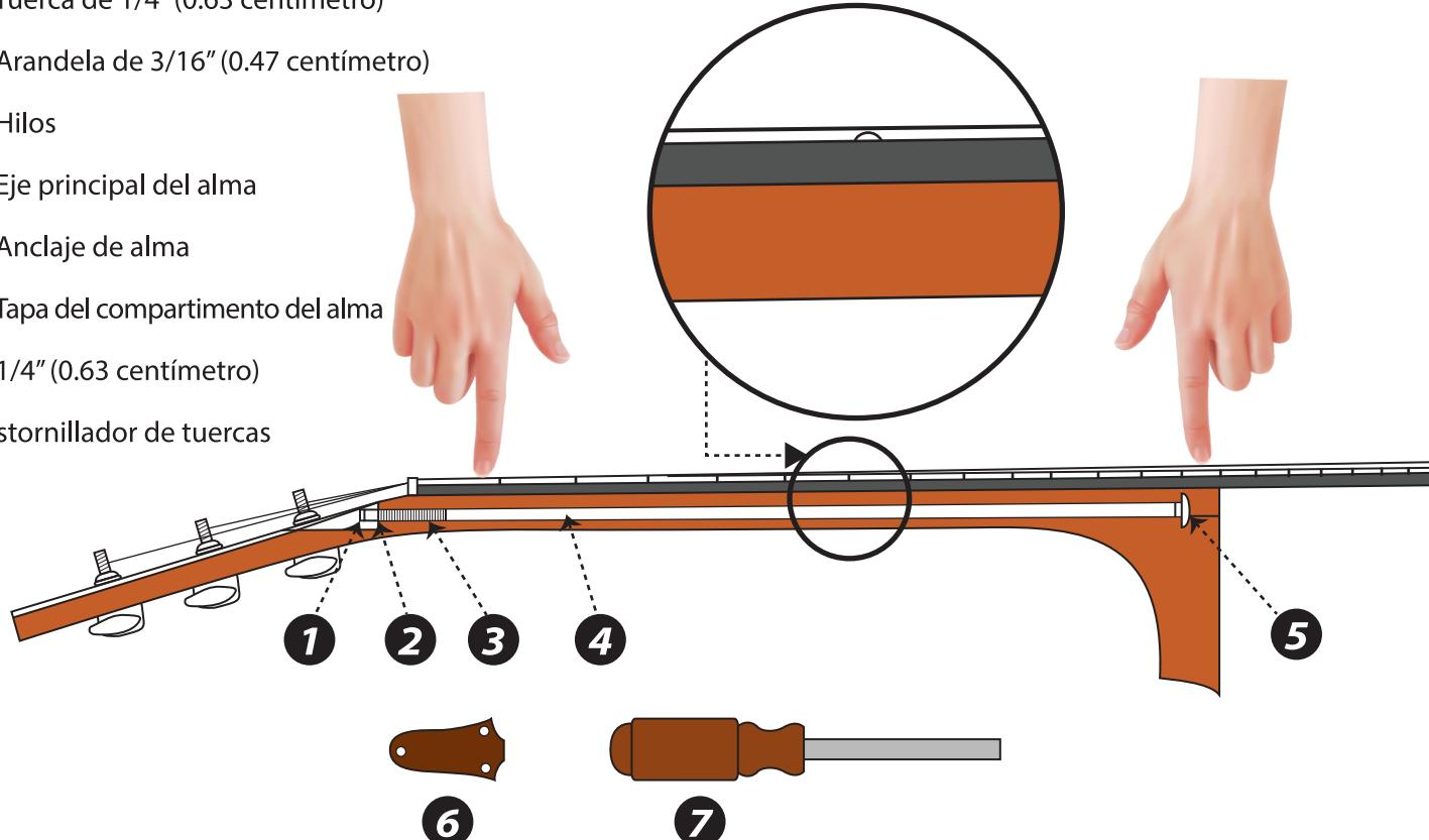
*A medida que presiona la cuerda hacia abajo en los trastes 1 y 14, la cuerda debe estar aproximadamente a .010" (0.25 centímetro) del 6 traste, aproximadamente el grosor de una tarjeta de presentación.*
