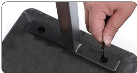
**ÉTAPE 1:** Utilisez la clé Allen pour visser les pieds dans le siège. Les trous pour les renforts doivent être orientés vers l'intérieur, tandis que les trous pour les boutons doivent être orientés dans la même direction
